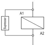
A1 e A2 são os bornes da bobina da contadora.
